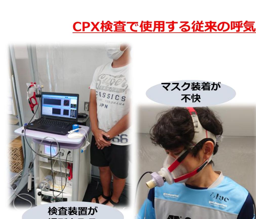
CPX検査で使用する従来の呼気ガス分析装置検査
